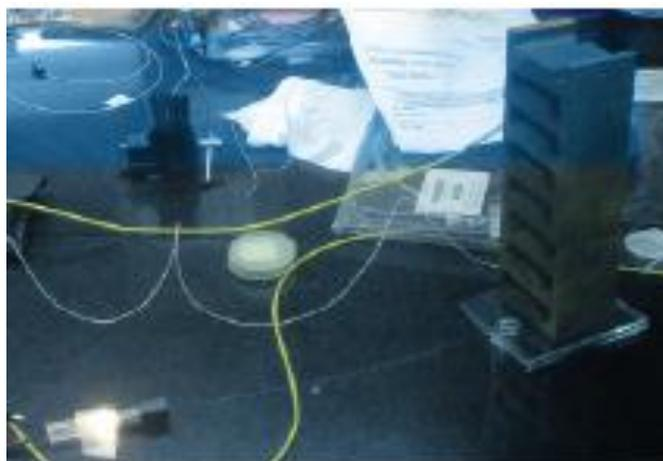
Figura 3: LPG com a torre de massa 4,06 kg.
