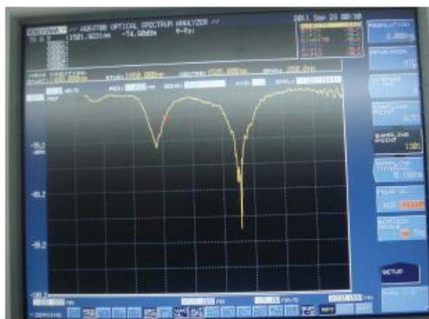
Figura 4: Espectro de transmissão da LPG mecânica com pressão feita por 4,06 kg de massa.
