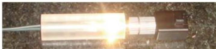
Figura 2: Lâmpada com filamento de tungstênio com luz de espectro longo.
