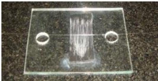
Figura 1: Foto da LPG mecânica com a fibra óptica sobre os 40 grafites.
