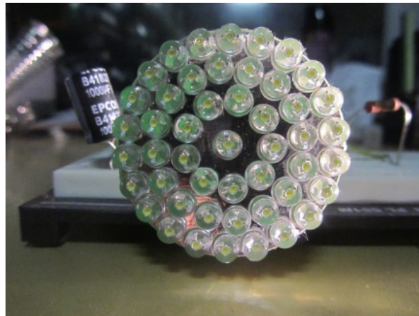
Figure 14: Protótipo UFF - 50 LEDs 10000 mCandelas
