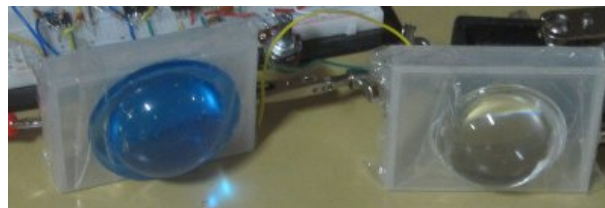
Figure 16: Lentes do receptor com e sem filtro azul
