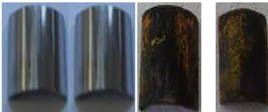
Figura 14: Amostras 13 e 14 antes e depois do ensaio de corrosão (Foto: Vanessa Kapps)
