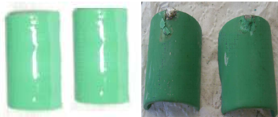
Figura 15: Amostras 15 e 16 antes do início do ensaio de corrosão (Foto: Vanessa Kapps)
