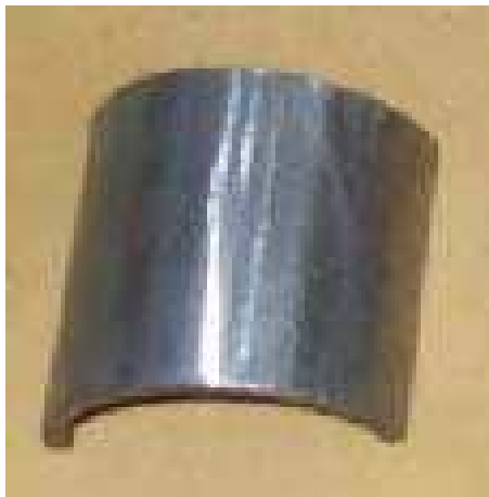
Figura 3: Corpos de prova depois de lixados e polidos.
