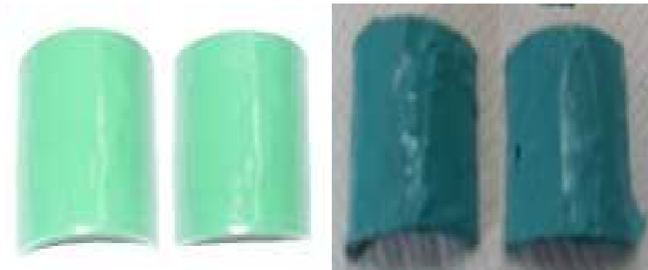
Figura 9: Amostras 3 e 4 com revestimento orgânico antes e depois do ensaio de corrosão (Foto: Vanessa Kapps)
