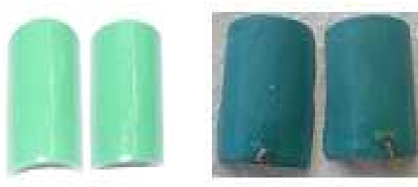
Figura 11: Amostra 7 e 8 com revestimento antes e depois do ensaio de corrosão (Foto: Vanessa Kapps)
