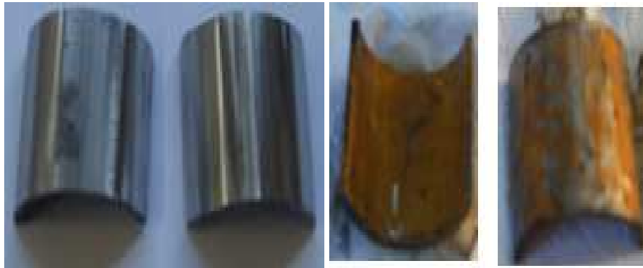
Figura 13: Amostras 11 e 12 sem revestimento orgânico antes e depois do início do ensaio de corrosão (Foto: Vanessa Kapps)
