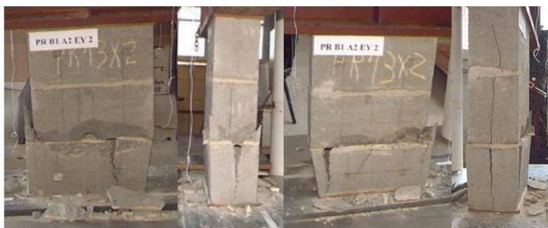
Figura 3: Modelo de ruptura do Prisma [13]
