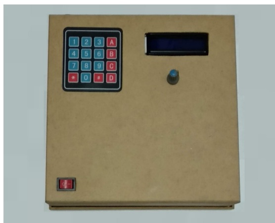
Figura 13: Caixa para proteção dos circuitos e de fácil acesso a IHM
