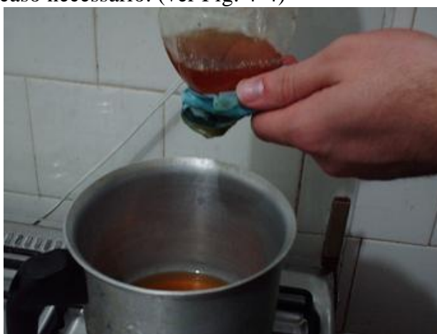
Fig.4-4 Filtração do óleo
