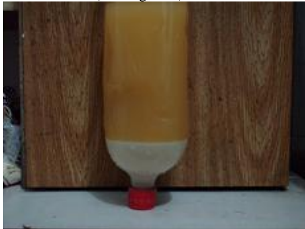
Fig. 4-8 Purificando o biodiesel
