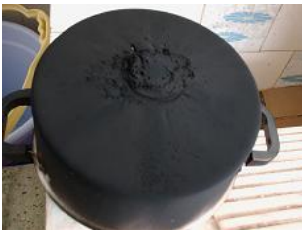
Fig. 5-2 Camada de fuligem após teste
