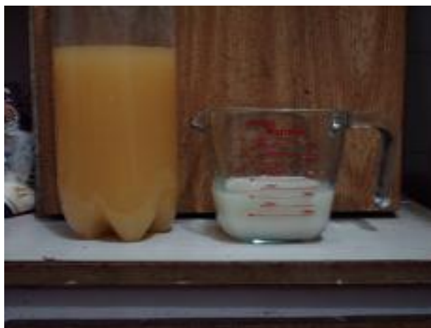
Fig. 4-9 Biodiesel após purificação
