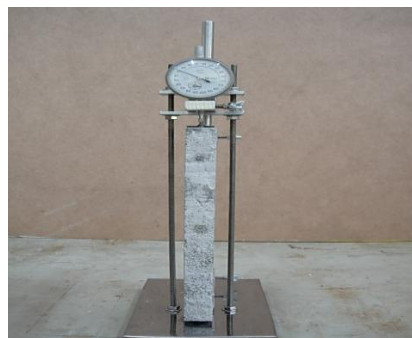
Figura 4 - Medição da expansão do comprimento da barra de argamassa no ensaio de RAA (KITAMURA, 2011).
