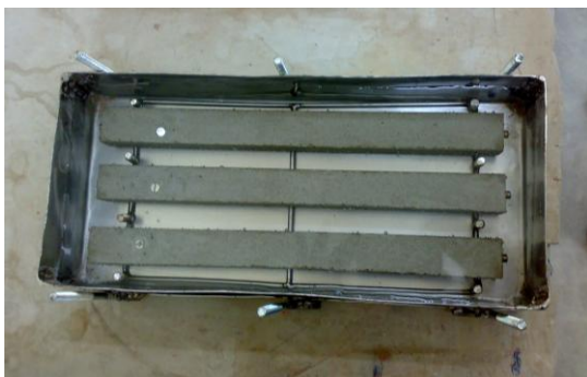
Figura 3 – Barras de argamassa imersas em solução de hidróxido de sódio no ensaio de RAA (KITAMURA, 2011).
