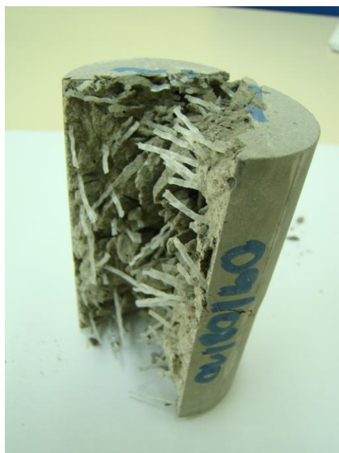
Figura 5: Corpo-de-prova com 5% de fibra com rompimento por tração
