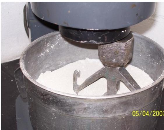
Foto 3.1 – Material seco em processo de mistura para produção do RPC
