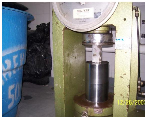
Foto 3.4 – Corpo de prova de RPC sendo testado à compressão.
