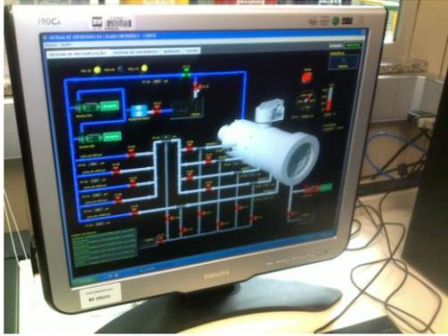
Foto 4.1 – Painel de controle de pressão do ensaio simulador do CENPES. .
