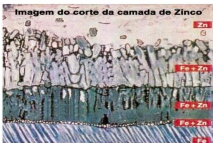
Figura 3: Camadas de zinco formadas após galvanização [1]
