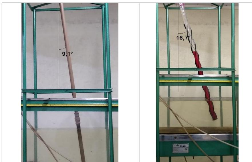
Figura 6: Medição do ângulo de topo para o tubo liso (à esquerda) e com *strakes* (à direita) para velocidade de 0,158 m/s
