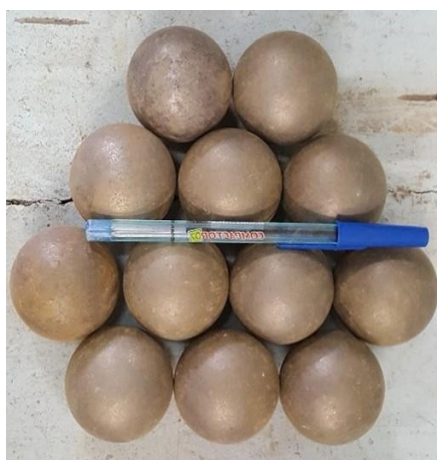
Figura 5: Esferas utilizadas como cargas abrasivas para o processamento dos resíduos
