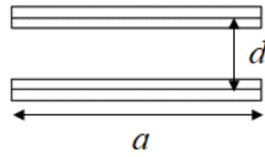
Figura 3: Condutores idênticos em paralelo
