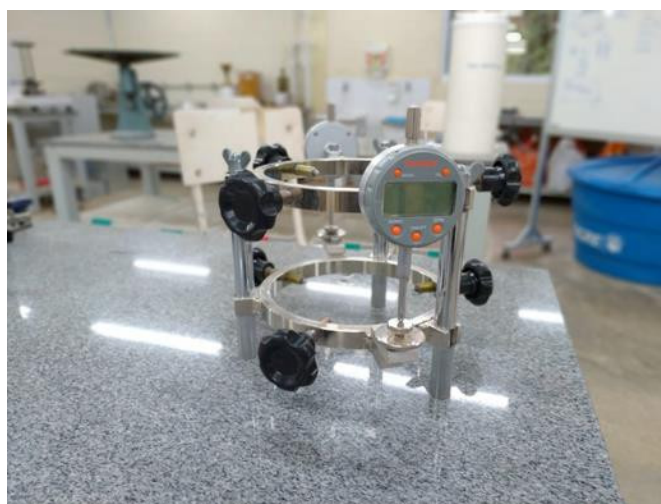
Figura 1: Aparato utilizado no ensaio para o módulo de elasticidade estático
