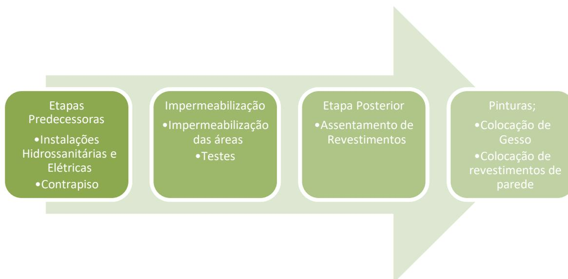
Figura 3: Fluxo de serviço em Impermeabilização com revestimento cerâmico aplicado diretamente
