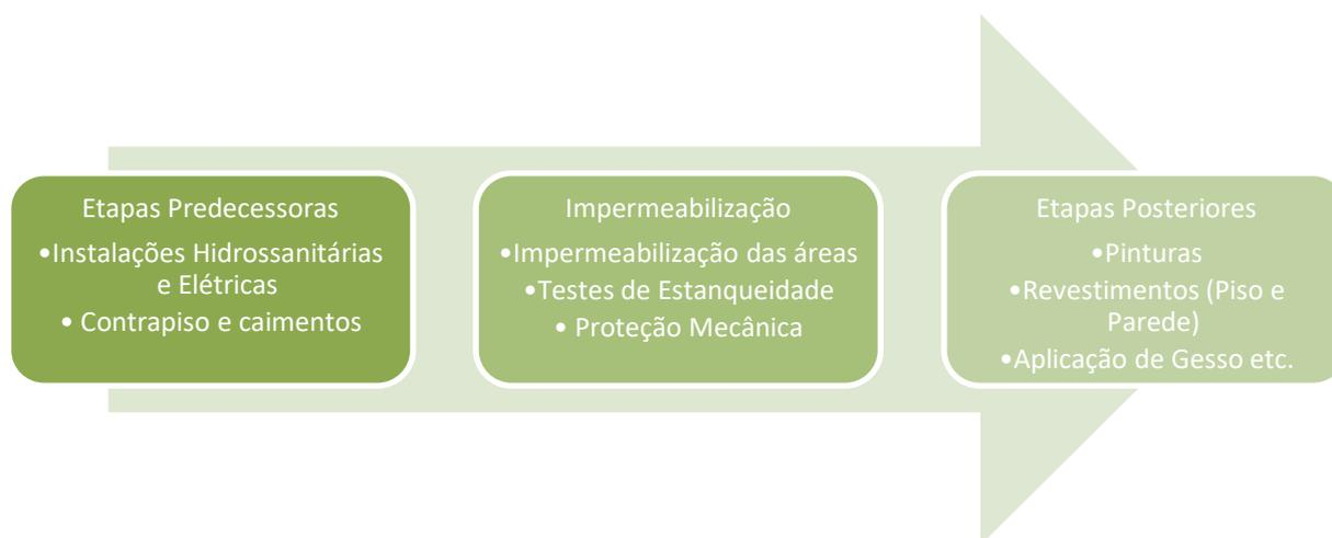
Figura 4: Fluxo de trabalho com Impermeabilização com Proteção Mecânica
